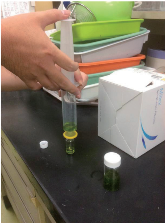
写真 7 マイクロフィルターにて濾過している様子
