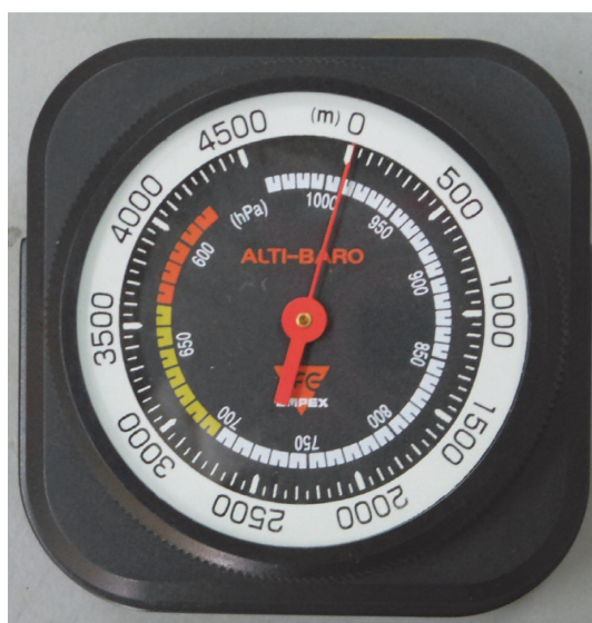
写真4 付属の600hPaまで計れる気圧計
