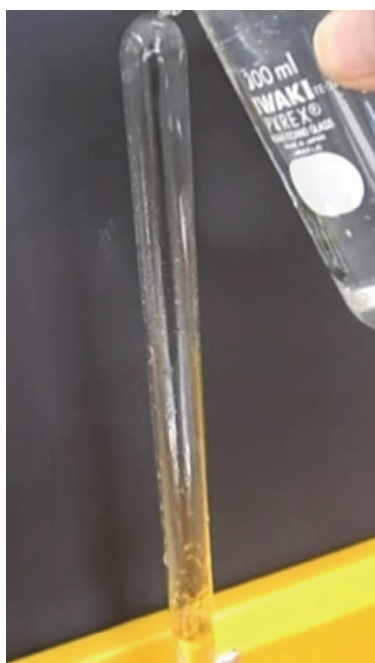
写真13 水をかけると一気に液面上昇
