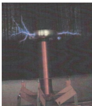
写真102 この当時のテスラコイルの放電の様子 ネオントランスが3つ使われていた。また、放電ギャップはロータリー式だった。
