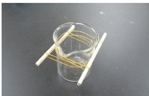
図6 ピーカーを割り箸で挟む
