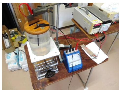
図4 陽極酸化装置(実際)
