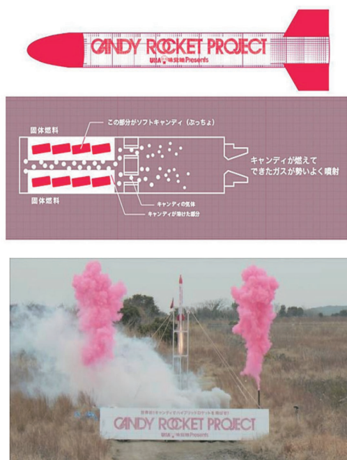
図2 キャンディロケットエンジンの原理と打ち上げの様子
