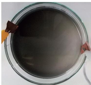
図7 電気泳動の実験(左:陽極、右:陰極)
