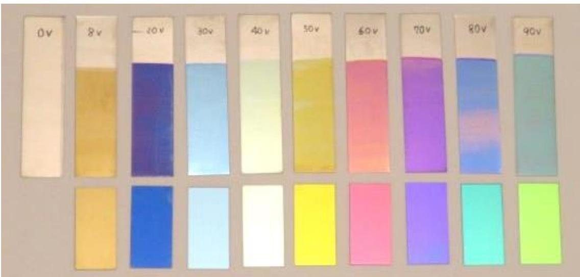
図9 (株)中野科学の発色板との比較（上段：本実験の製品，下段：中野科学製）
