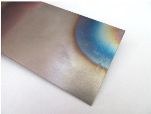
図 1 加熱酸化による発色
