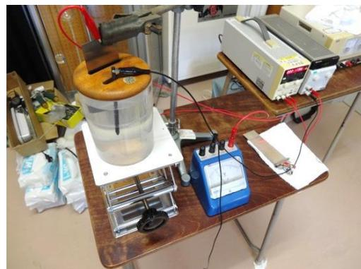
図 4 陽極酸化装置（実際）
