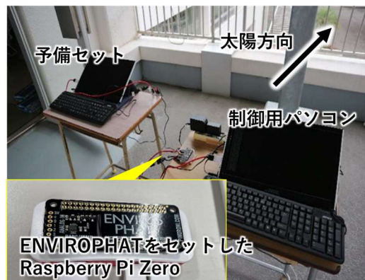
図10 Raspberry Pi を用いた照度観測
