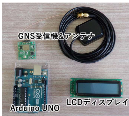
図 6 自作 GPS 時計の材料
