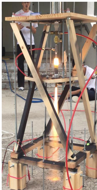
図 6 燃焼実験の様子 燃料が赤熱し、燃焼ガスが勢いよく噴射されている。
