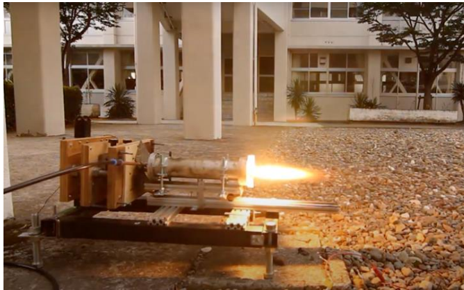
図18 燃焼実験の様子 中央のエンジンは滑走台の上に乗っており推力が発生すると前方のロードセルを押し推力が記録される仕組みである。
