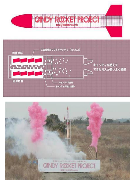
図2 キャンディロケットエンジンの原理と打上げの様子
