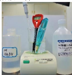
写真4 緩衝液に水酸化ナトリウム水溶液を滴下しpH測定
