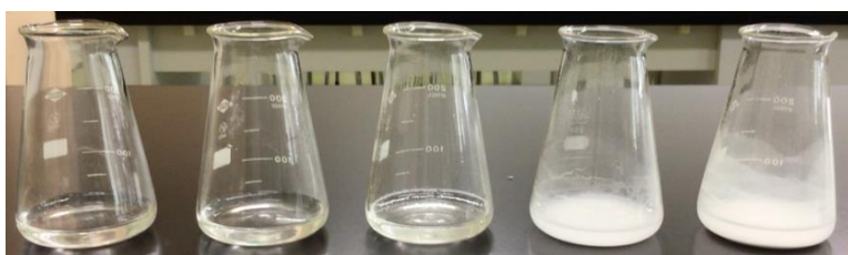
写真 4 炭酸カルシウムを加えた反応後の様子 左から 0.50 g，1.00 g，2.00 g，3.00 g，4.00 g のもの
