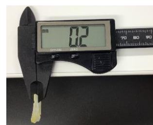
写真 13 作製した薄貝の測定
