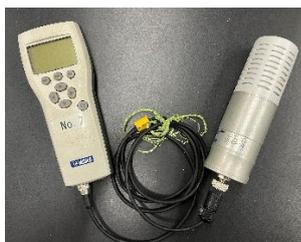
図 2 赤外線ガス分析器 (左) と小型 CO<sub>2</sub> 濃度計 (右)
