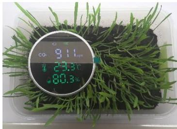
図6 呼吸速度の測定(密閉前)
